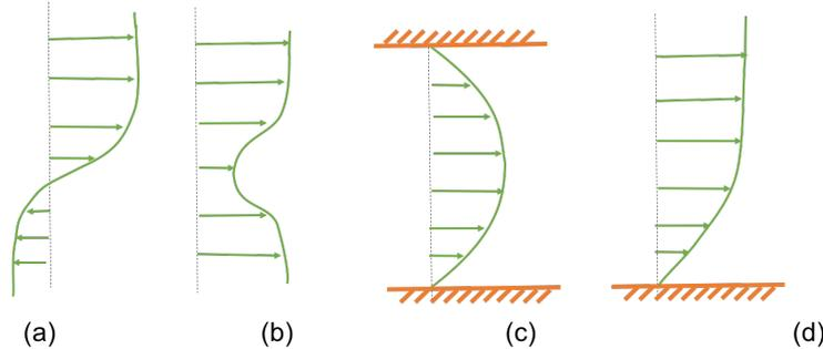
On considère 4 exemples d'écoulement parallèle d'un fluide incompressible représentés par les profils (a), (b), (c), (d) ci-dessus. Pour chacun des cas, expliquez la signification physique de l'écoulement (dans quels contextes ou applications ce type d'écoulement est-il rencontré) puis discutez ses propriétés de stabilité. A quel type d'instabilités peut-on s'attendre? Argumentez en vous basant sur les notions vues en cours (notamment les critères classiques de stabilité).
